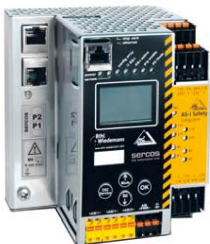
AS-I 3.0 sercos-Gateway mit integriertem Sicherheitsmonitor und sicherer Querkommunikation über Ethernet
