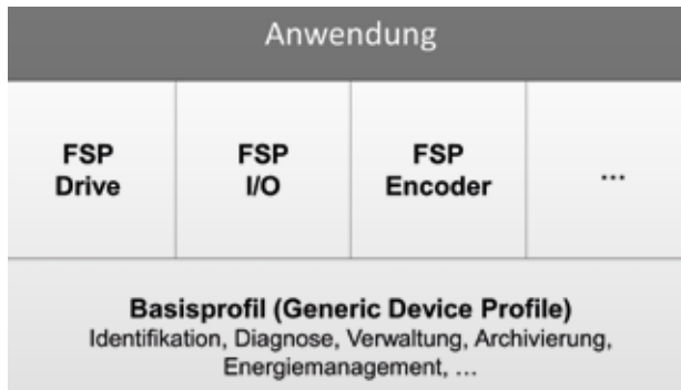
Profilstruktur von sercos-III-Geräten
