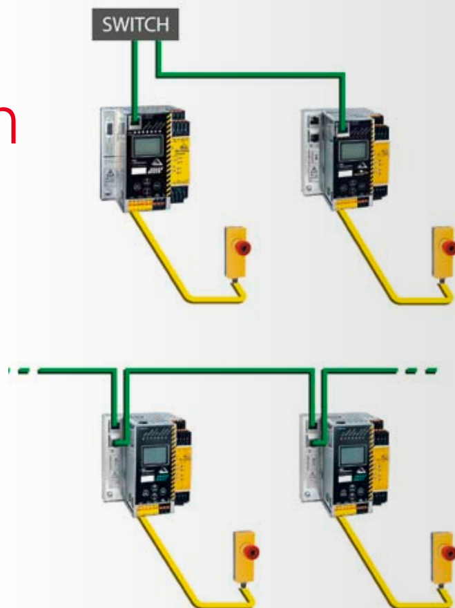
Sichere Querkommunikation über Ethernet-Diagnoseschnittstelle (oben) und über Feldbusschnittstelle
